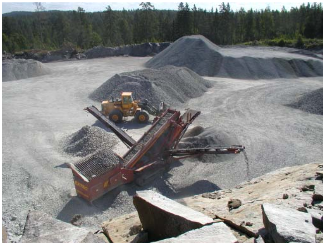
Figur 2. Betongtillverkning ställer krav på de ingående grus- eller bergkrossningsmaterialen, bl a beroende på kornstorleken. Bilden visar sortering och siktning av bergkrossmaterial i olika kornstorlekar (fraktioner). Foto: Gustaf Magnusson.
